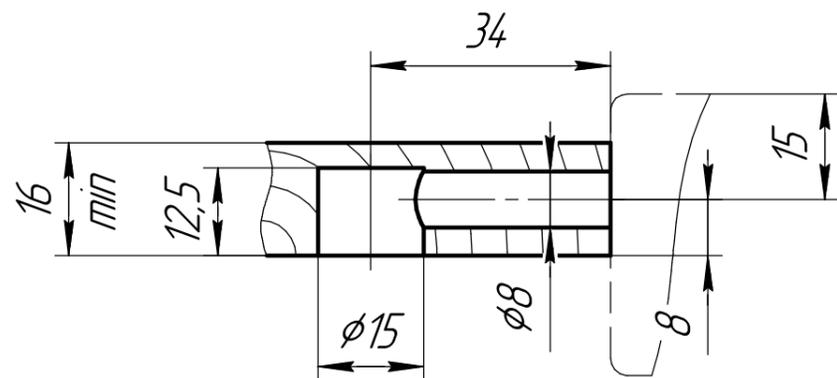
Рис. 1 Вариант отверстия в панели ЛДСП для эксцентриковой стяжки  $\phi 15$  со штоком эксцентрика M6x34
