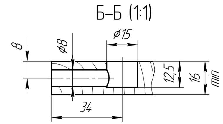
Рис. 2 Вариант отверстия в панели ЛДСП для эксцентриковой стяжки  $\phi 15$  со штоком эксцентрика М6х34
