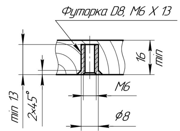
рис. 1 Вариант отверстия M6x13 для винта M6x12.
