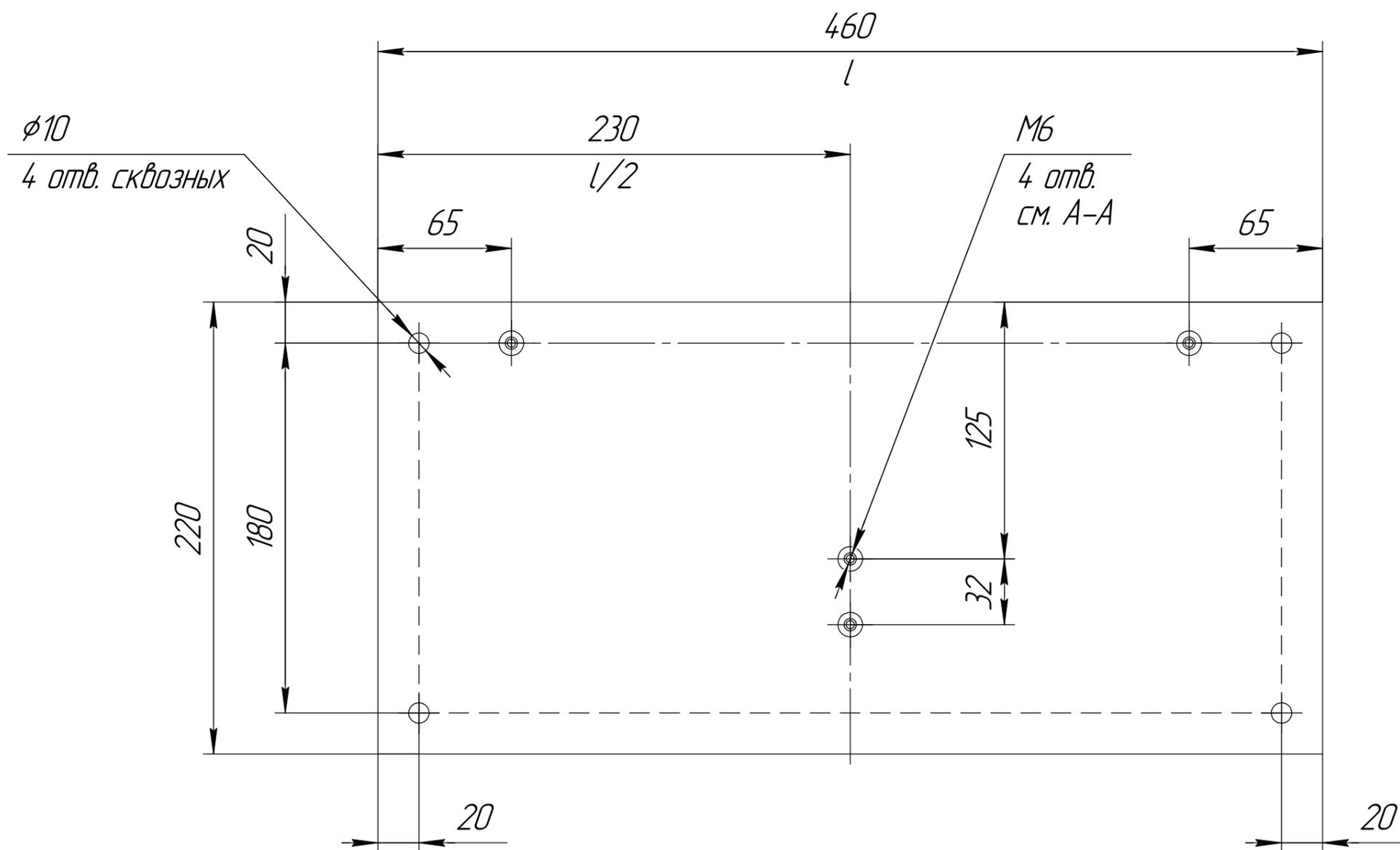
Расчёт длины экрана ДСП в зависимости от длины столешницы  $L$ :
